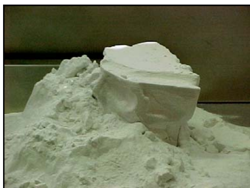
Fig. 17 - Biomodelo parcialmente coberto pelo pó não sinterizado, que funciona como suporte, na técnica de SLS.
