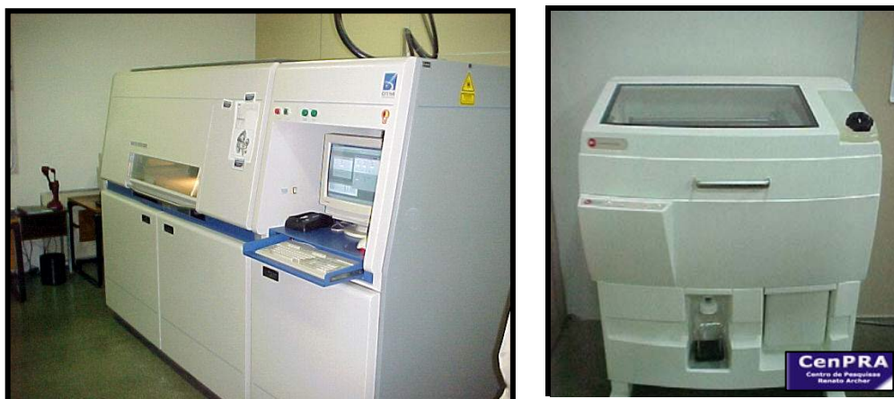
Fig. 29 - Aparelho de SLS ( Sinterstation 2000 – DTM. EUA), pertencente ao LTDDP-CenPRA, Campinas-SP.
