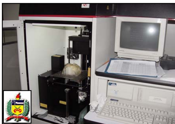
Fig. 14 - Aparelho SLA-250, 3D Systems (EUA), pertencente à UFSC, Florianópolis-SC, Brasil. FONTE: Meurer, 2002 .
